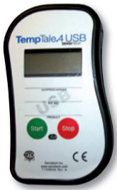
TEMPTALE4 USB: Monitort tijdens het volledige transport de binnentempera- tuur van de verpakking en maakt een gedetailleerd rapport van de metingen. Handig te lezen dankzij de USB-interface. Eenheidsprijs: € 42/stuk
